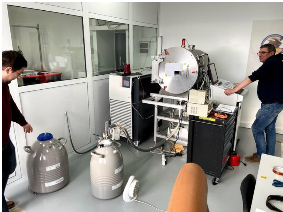
Cercetători ai ISS realizând teste climatice utilizând instalația de azot lichid
