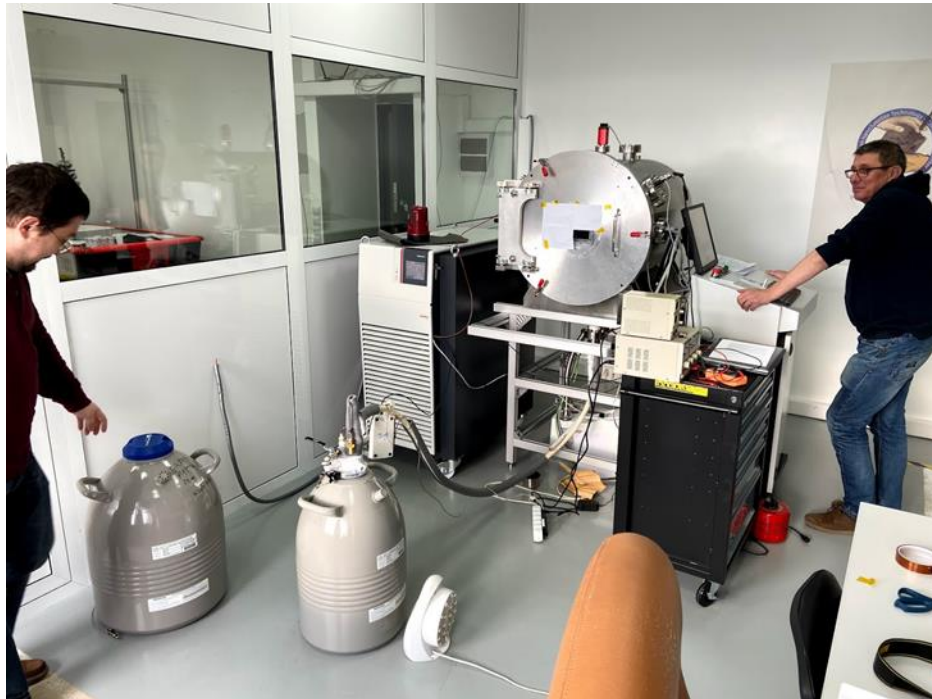
Instalație TVAC cu LN2
